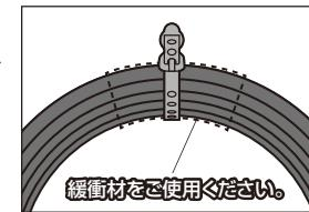
光ファイバケーブルを束縛あるいは固定する時に、HDMIコネクタと結線部を持って固定します。コネクタの結線部は強く引っ張らないように取扱います。
