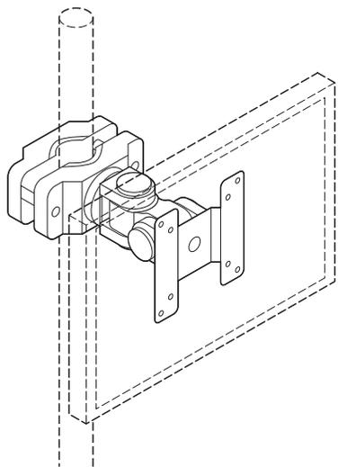
※直径25~40mmの垂直、または水平な支柱に取付け可能
