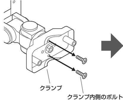
② クランプを90°回転させてボルトで固定します。
