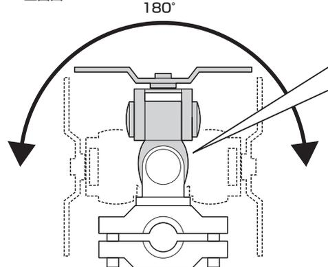
キャップをはずし、スパナでナットを締め付けて調節します。
