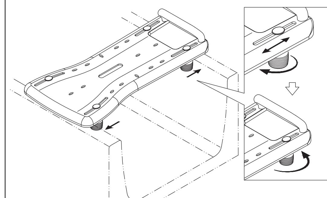
※ストッパーをゆるめて位置を調節し、浴槽の内側でボードが動かないように固定します。
