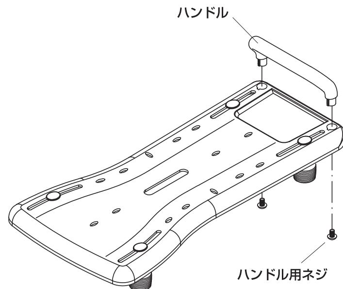
※コインなどでネジを回して固定します。
